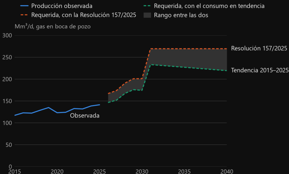
井口天然气产量，单位为百万m 3 /日：2015–2025年为观测值；2026–2040年为所需产量，分别按Resolución 157/2025（第157/2025号决议）设定的消费量和趋势消费量计算。两条路径均计入SESA的浮式液化天然气装置，并自2031年起计入Argentina LNG第一阶段■ 39 。图中文字为西班牙文。
